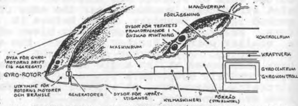
HALVA "TEFATET" I A 7:s slutliga gestalt i genom- och ursidning. Den rötande rympen ger förkastat dess form av "tefat". Rympen skall drivas av fyra rymtdrivare av samma utformning som på V 2 med en öppning för ägret av luft. Framdrivningsverket består av 8 parvis kopplade liknande äggrar.
